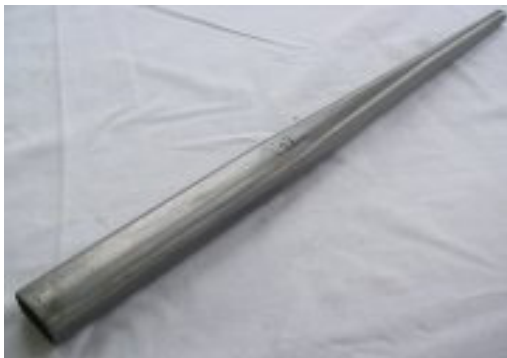
Kettenstrebe Dedacciai COM 24x0.8/0.6x410mm Quadra Form 24x19mm 12.5mm am Ausfallende
