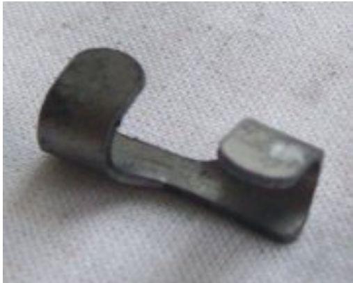
Kabelführung f. geschlossene Züge Stahl 1.8g
